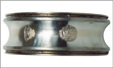
照片1-3 ● 深沟球轴承的内圈。 ● 沟道面上产生呈球距分布的剥落。 ● 由安装时冲击载荷造成的压痕发展成
