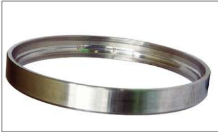
照片1-5 ●照片1-4的外圈。 ●沟道面上产生呈球距分布的剥落。 ●停机时冲击载荷造成的压痕发展而成。
