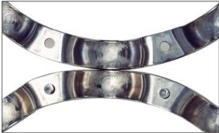
照片3-7 ● 深沟球轴承的保持架。 ● 钢板冲压保持架兜孔处的擦伤。 ● 异物侵入造成的损伤。
