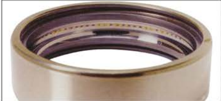
照片 15-6 ●深沟球轴承的外圈。 ●滚道面上的条纹状电蚀（高频）。
