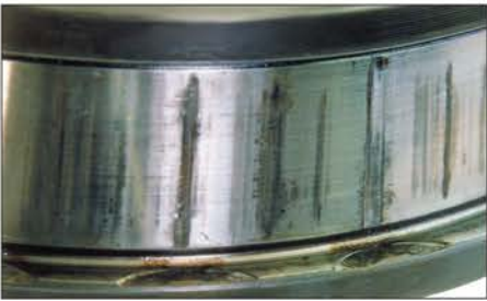
照片10-3 ●双列圆锥滚子轴承的内圈。 ●挡边面上的阶梯状磨损与滚道面上的微动磨损。 ●静止状态下承受过大载荷，由微动磨损发展而成的损伤。
