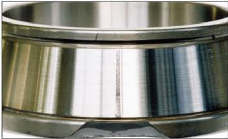
照片5-2 ● 圆锥滚子轴承的内圈。 ● 大挡边上的破裂。 ● 由安装时受到的过大冲击造成。
