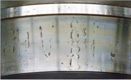
照片 16-3 ●调心滚子轴承的内圈。 ●滚动面上的锈蚀呈滚子间距分布。 ●水分侵入润滑剂中造成的。
