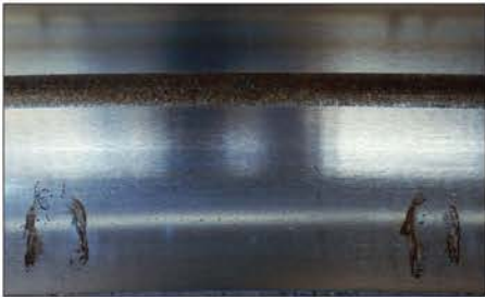
照片 16-2 ●回转支承轴承的外圈。 ●滚动面上的锈蚀呈等球距分布。 ●停机时水分凝结造成的。
