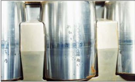
照片 16-4 ●调心滚子轴承的滚子。 ●滚动面上产生的凹坑状锈蚀。 ●保管过程中水分凝结造成的。
