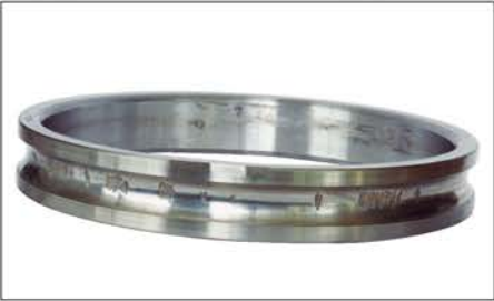
照片 1-4 ● 角接触球轴承的内圈。 ● 沟道面上产生呈球距分布的剥落。 ● 由停机时冲击载荷造成的压痕发展成。
