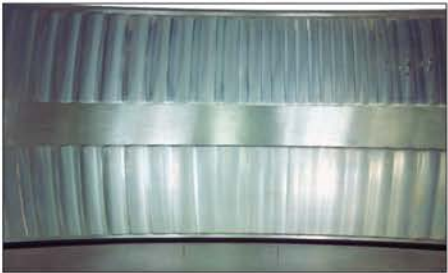
照片10-2 ●调心滚子轴承外圈。 ●承载区滚道面上凹凸不平的波状磨损。 ●静止状态下反复振动，由异物侵入而造成的损伤。
