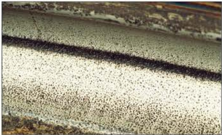
照片9-1 ●回转支撑轴承的外圈。 ●滚道面呈现梨皮状，凹坑底部已被腐蚀。
