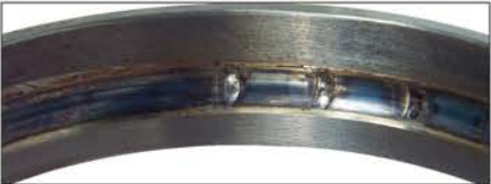
照片14-4 ● 照片14-3的外圈。 ● 滚道面变色，出现呈等球距分布的熔融痕迹。 ● 预紧过大造成的损伤。
