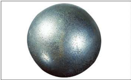
照片9-2 ●照片9-1的钢球。 ●滚动面呈现梨皮状
