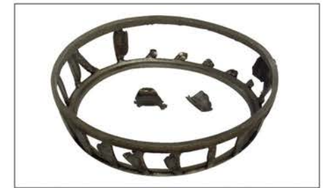
照片7-4 ● 圆锥滚子轴承的保持架。 ● 钢板冲压保持架梁折断。
