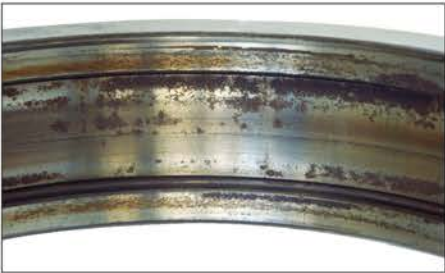
照片 16-1 ●圆柱滚子轴承的外圈。 ●滚动面及挡边上生锈。 ●原因是由于进水造成润滑不良。
